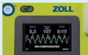
ZOLL CPR Dashboard™ ger återkoppling i realtid med värden för HLR-djup, frekvens och cykeltid.
